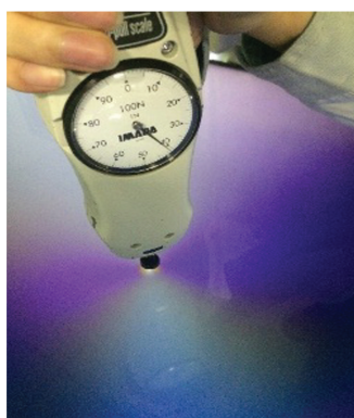
图 3 加压测试漏光现象
